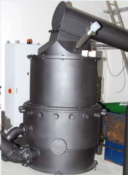
In der Heißgasfiltereinheit mit seitlichem Ascheaustrag wird das erzeugte Holzgas von Partikeln gereinigt.
